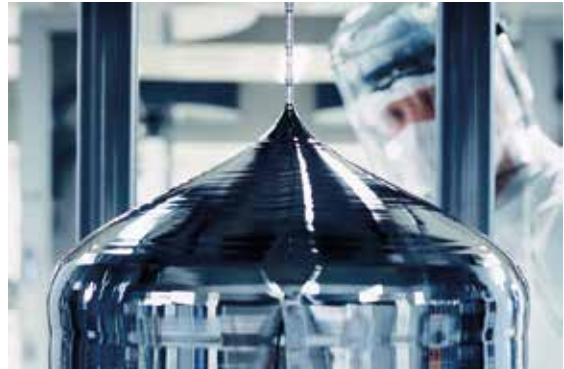
Im Fertigungsprozess wird Polysilizium eingeschmolzen und zu bis zu drei Metern langen Stäben gezogen.
