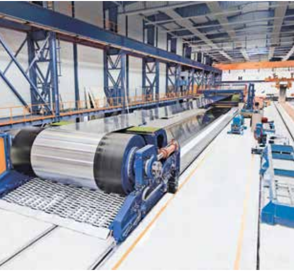
Hochpräzisionsanlage zum Schleifen von Stahlbändern in der Produktion der Berndorf Band Group.
