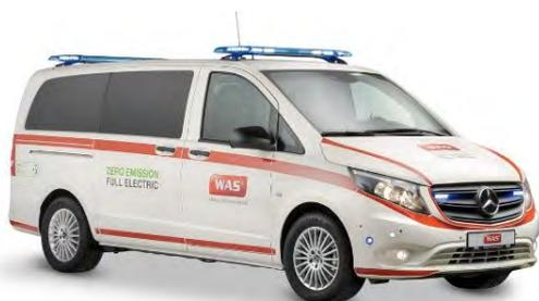
Insgesamt bietet dieses Fahrzeug eine überdurchschnittliche Zuladung von 610 kg. Bei einem berücksichtigten Gewicht der Besatzung von 3 x 75 kg, kann von einer Restkapazität von 385 kg profitiert werden. Neben der in der DIN EN 75079 geforderten Gewichtsreserve erfüllt dieses Fahrzeug auch die weiteren Anforderungen der aktuell geltenden Norm für Notarzteinsatzfahrzeuge.
