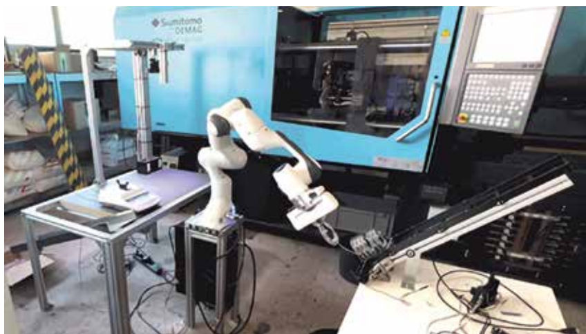
Aus einer roboterunterstützten Fotosession mit Spritzgussteilen entstand eine „Anomalie-Heatmap“ zur Fehlererkennung.
